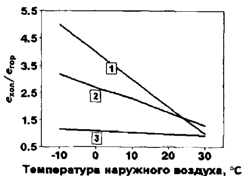
Рис. 7. Эмиссия токсичных веществ при холодном и горячем пуске двигателя: 1 – CO; 2 – CH; 3 – NOx
