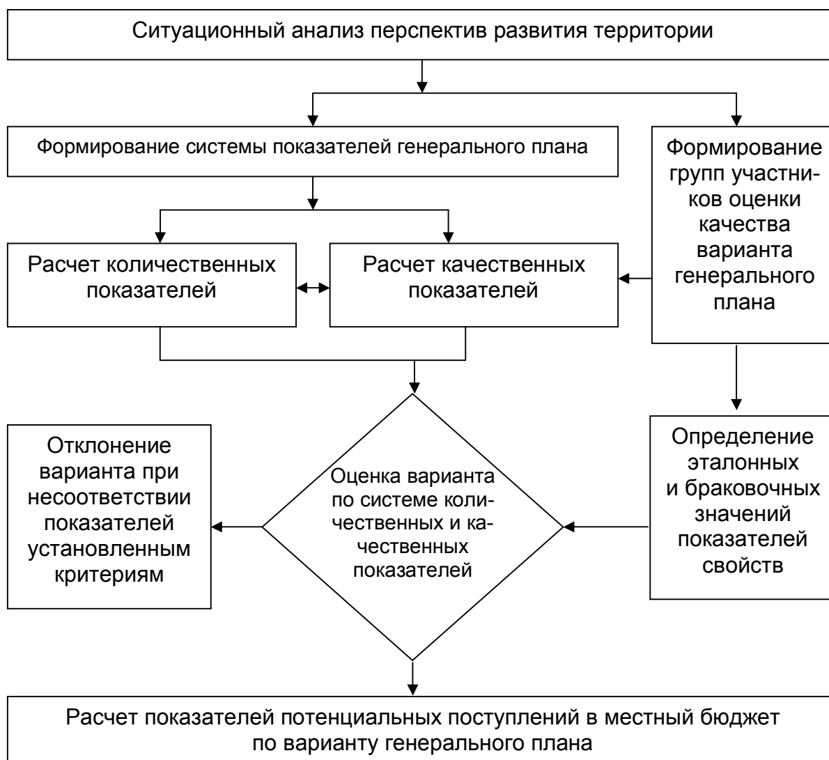
Рис. 1. Блок-схема оценки качества варианта генерального плана
